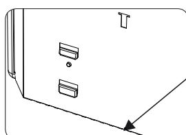
Na dnu zadnje strani grelnika se nahajata dve majhni trikotni tirnici. Grelnik namestite na tirnice in potisnite grelnik proti zagozdam na vrhu okvirja v pokončnem položaju.
