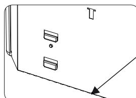
An der Unterseite der Rückplatte befinden sich zwei kleine, dreieckige Schienen. Setzen Sie das Gerät auf die Schienen und drücken Sie das Gerät in aufrechter Position gegen die Lippen oben auf der Halterung.
