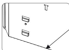
A hátlap alján két kis háromszög alakú sín található. Helyezze a fűtőpanelt a sínekre és nyomja a berendezést függőlegesen a rögzítőkonzol felső részén található fülek felé.
