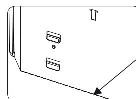
Na dnu radijatora sa zadnje strane nalaze se simboli dva mala trougla. Radijator treba spustiti na zidni nosač tako da se kuke na donjem delu nosača poklapaju sa simbolima trouglova na radijatoru. Zatim gornji deo radijatora treba gurati ka zidu sve dok klipsevi na gornjem delu zidnog nosača ne upadnu u odgovarajuća ležišta na radijatoru.
