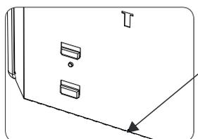
An der Unterseite der Rückplatte befinden sich zwei kleine, dreieckige Schienen. Setzen Sie das Gerät auf die Schienen und drücken Sie das Gerät in aufrechter Position gegen die Lippen oben auf der Halterung.
