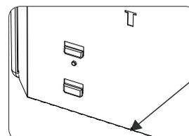
Na dnu radijatora sa zadnje strane nalaze se simboli dva mala trougla. Radijator treba spustiti na zidni nosač tako da se kuke na donjem delu nosača poklapaju sa simbolima trouglova na radijatoru. Zatim gornji deo radijatora treba gurati ka zidu sve dok klipsevi na gornjem delu zidnog nosača ne upadnu u odgovarajuća ležišta na radijatoru.
