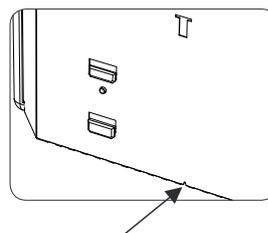
Nederst på bakplaten er det to trekantspor. Disse trees inn på veggfestet. Trykk deretter øvre del av ovnen mot de øvre leppene på festet.
