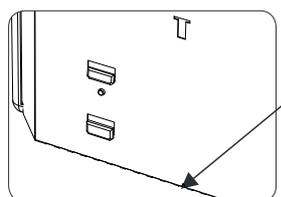
Il y a deux petits rails triangulaires au bas du panneau arrière. Placez l'appareil sur les rails et appuyez sur l'appareil en position verticale contre les lèvres sur le dessus du support.
