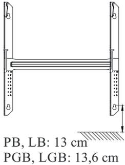
**Фиксиране на стенната конзола:**
